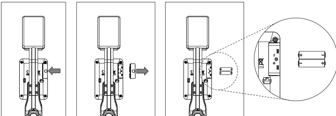
Nel momento in cui il display del computer è debole o spento è necessario sostituire la batteria. Il computer è dotato di due batterie. Procedere con la sostituzione della batteria come descritto di seguito:
