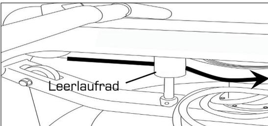
Als nächstes fädeln sie den Gurt um das Leerlaufrad. Sobald der Gurt um das Leerlauf-rad geführt ist befestigen sie ihn am Gurt und Seilrad. Die korrekte Stelle ist mittels eines klar sichtbaren Rand gekennzeichnet.
