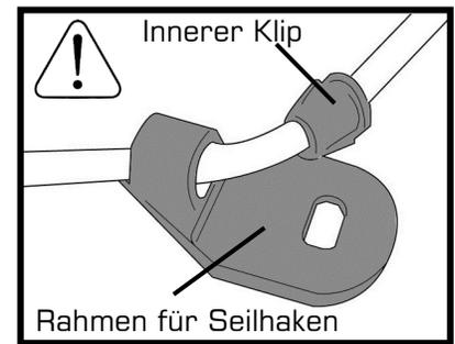
2. Nehmen sie den Haken aus der Halterung am hinteren Fuß und drücken sie den inneren Klip nach unten. Drücken sie das Seil durch den Klip bis es frei wird. Dadurch wird ermöglicht, dass das Seil komplett aus dem Hauptrahmen und dem Gurtrad ausgeführt wird und sich somit spatter wieder richtig dort anbringen läßt, sobald der Rudergurt wieder in der richtigen Position ist.
