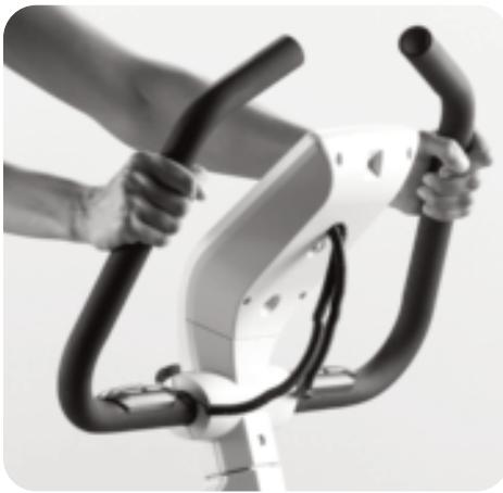
De helling van het stuur van uw hometrainer kan aangepast worden. Los de schroef onder de cockpit en stel de voor u optimale positie in. Draai daarna de schroef weer vast, zodat het stuur niet wegglijdt!
