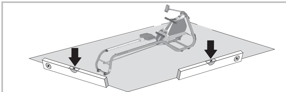
Der Standort des Geräts muss so gewählt werden, dass ausreichende Sicherheitsabstände zu Hindernissen gewährleistet sind. In unmittelbarer Nähe von Hauptlaufrichtungen sollte das Aufstellen unterbleiben. Der Freibereich muss umlaufend mindestens 1 Meter größer als der Übungsbereich sein.
