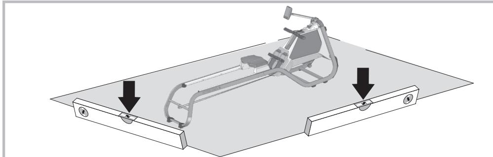
L'emplacement de l'appareil choisi doit garantir une distance de sécurité suffisante par rapport aux obstacles. Il faudrait éviter l'installation à proximité immédiate des voies de passage principales. La zone libre doit être plus grande que la zone d'exercice d'au moins 1 mètre en circonférence.
